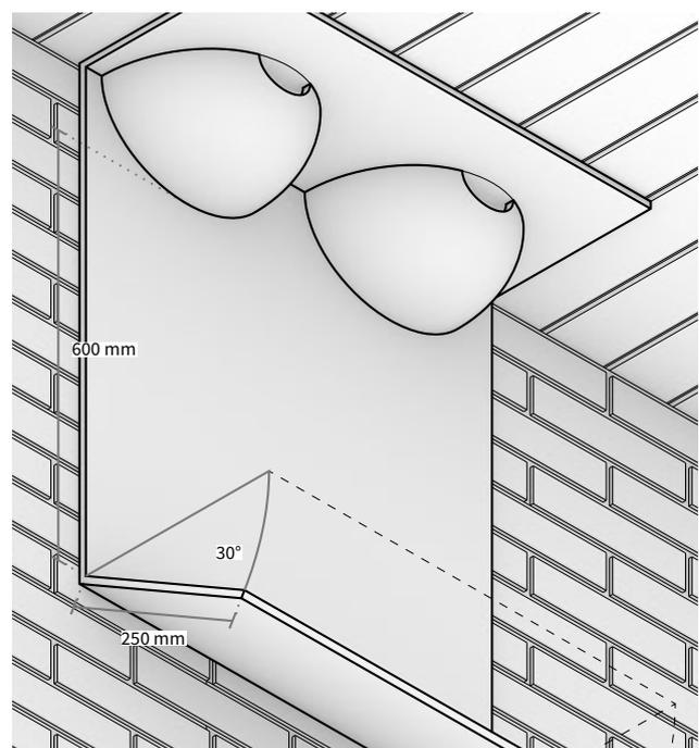
Zwei Nistplätze für Mehlschwalben, mit angewinkeltem Kotbrett, um die Fassade gegen Verunreinigungen zu schützen
